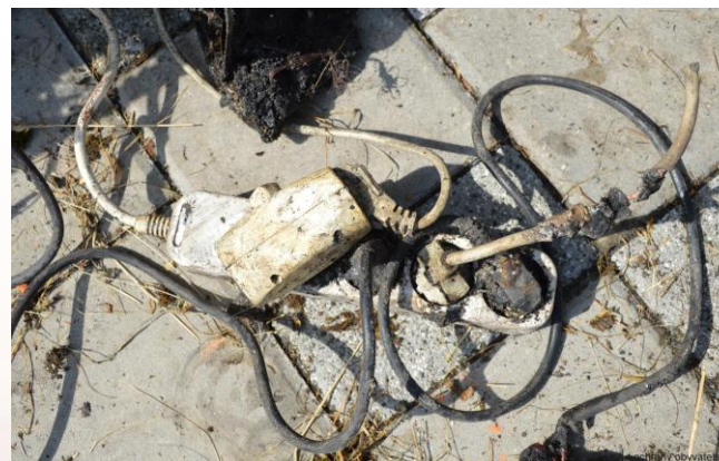
požár – přetížení zásuvkových obvodů
