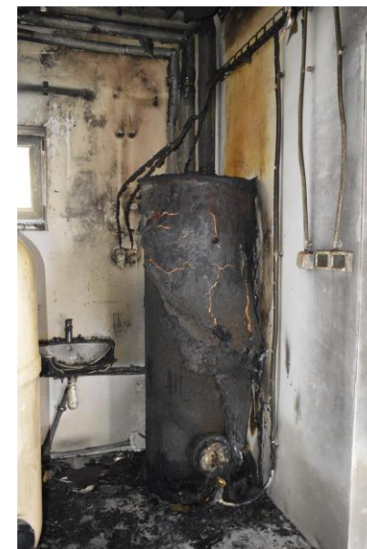
požár bojleru bez jištění
